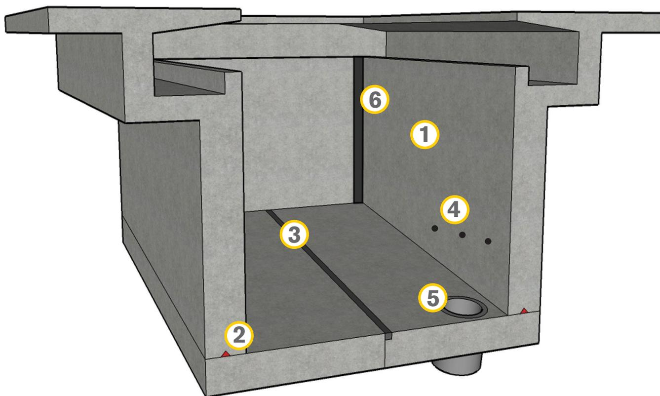
1. 使用凯顿公司的KIM混凝土防水外加剂直接添加到板和墙的混凝土中用于防水施工，全面保护建筑物内水分不被外来污染物的侵蚀。工艺详情请参看应用指南1.11-1.15——KIM混凝土防水外加剂的施工。
